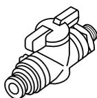
Vanne d'arrêt d'eau avec raccord enfichable 8 mm
